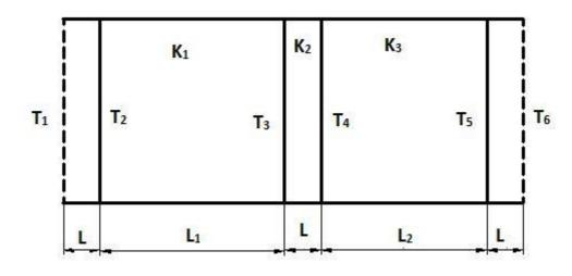
Given:  $K_1=1.5W/m^{\circ}C$ ,  $K_2=1$  W/m<sup>o</sup>C,  $K_3=4.9$  W/m<sup>o</sup>C,  $h_1=h_4=35$  W/m<sup>2</sup>K, T1=820°C, T6=110  $^{\circ}C$ , L1=L<sub>2</sub>=10 cm & L=1mm.
